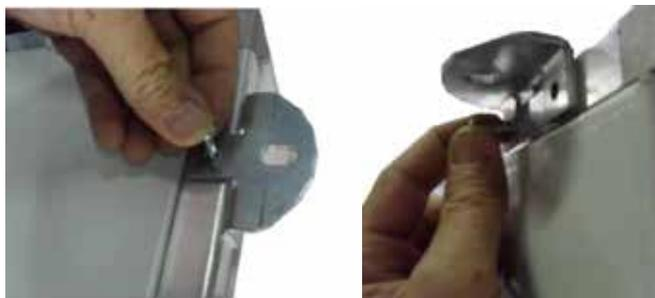
Figura 1 - Fissaggio delle staffe fornite a corredo
