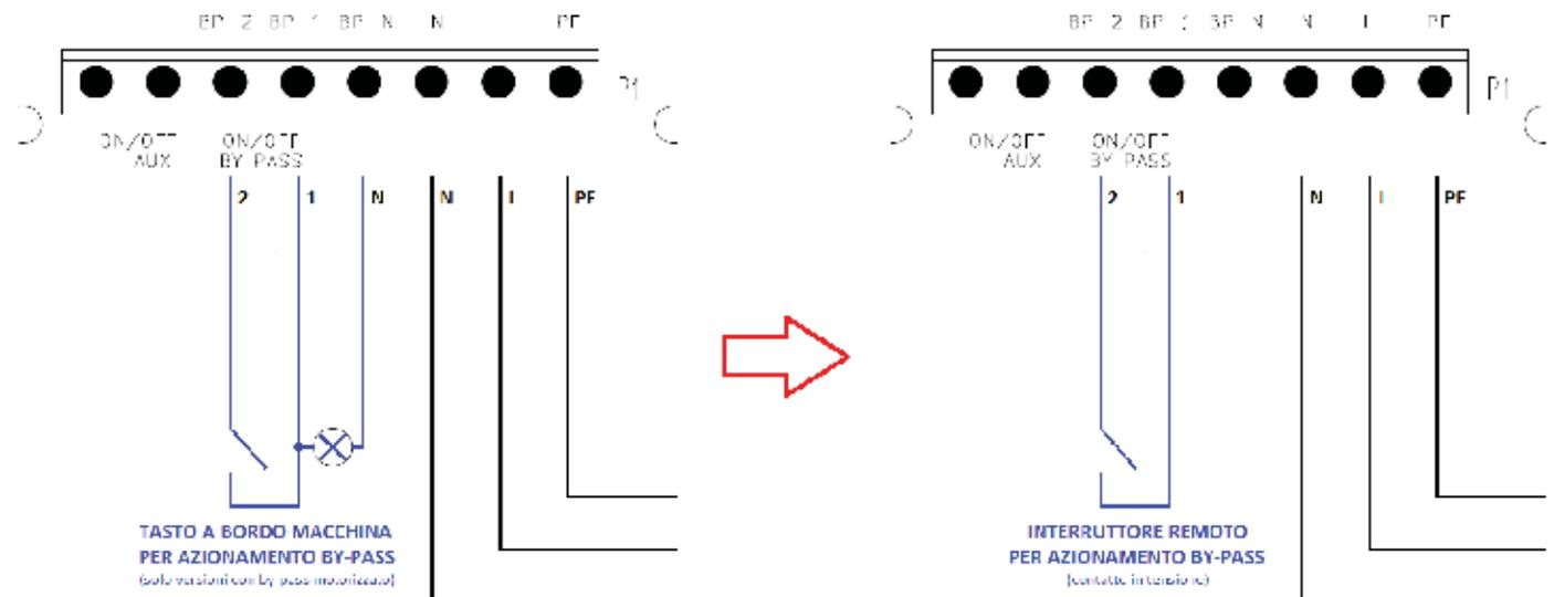
Figura 7 - Collegamento interruttore by-pass remoto
