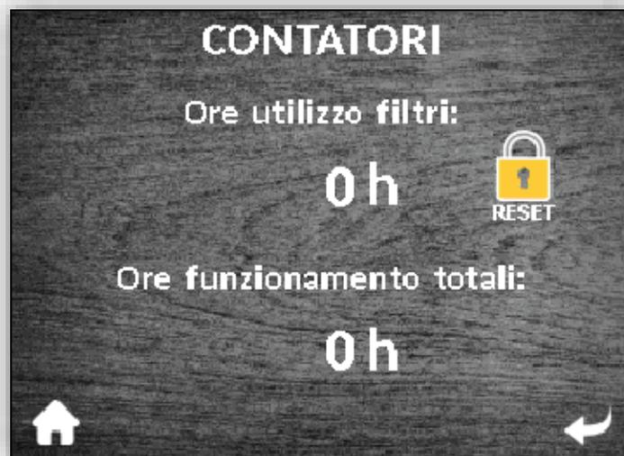
Per resettare il conteggio ore filtri dopo la verifica/sostituzione dei filtri è necessario procedere in questo modo:
