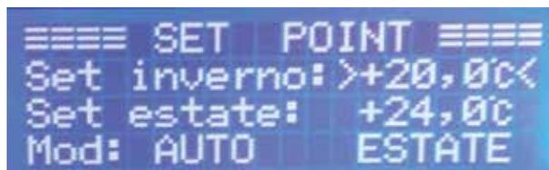
Nel caso in cui viene attivata la modalità di gestione a punto fisso del post-trattamento (parametro P103 = 1, solo con firmware 0.48 o successivo) è possibile accedere al menù **POST-TRATTAMENTO** continuando a scorrere le voci del menù **SET POINT** con la freccia GIU' (dopo la voce relativa alla stagione attiva):
