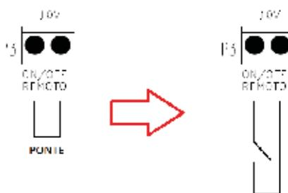
Figura 5 - Collegamento di dispositivo esterno per l'on-off remoto
