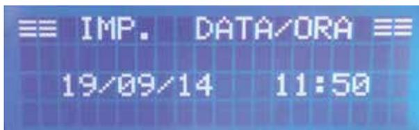
L'unità può essere gestita attraverso una programmazione oraria settimanale con la quale è possibile impostare lo spegnimento dell'unità o la selezione della velocità di funzionamento in base all'orario e al giorno della settimana.
