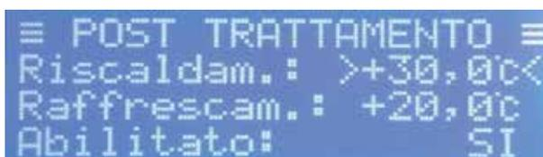
Dal menù **POST TRATTAMENTO** è possibile modificare le temperature di immissione in riscaldamento e in raffreddamento quando è attivo il post-trattamento (voci **Riscald.** e **Raffrescam.**, corrispondenti ai parametri P093 e P099): le impostazioni di fabbrica prevedono il set point di riscaldamento impostato a 30°C e quello di raffreddamento a 20°C. Inoltre, è possibile attivare o disattivare le funzioni di post-trattamento alla voce **Abilitato**.
