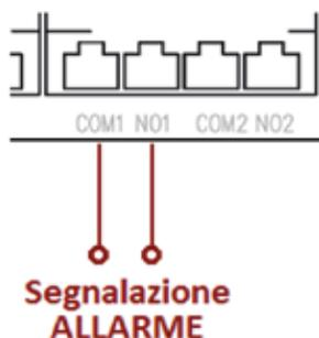
Figura 5 - Collegamento uscita segnalazione allarme
