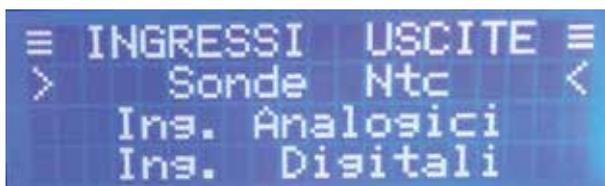
Il menù **INGRESSI USCITE** permette di verificare lo stato di tutti gli ingressi e le uscite della scheda di controllo; è strutturato in 5 sottomenù:
