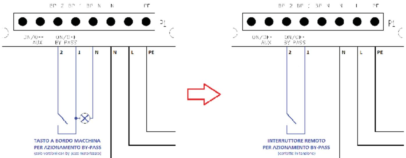
Figura 7 - Collegamento interruttore by-pass remoto
